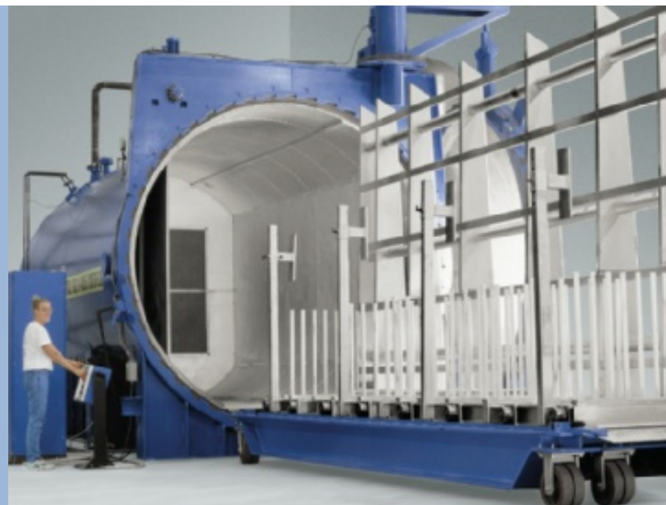
Autoklav zur Herstellung von Verbund-Sicherheitsglas Autoclave for the production of laminated glass
